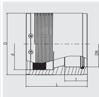
Переходник с полиэтиленовых труб (SDR 33- SDR17) на инженерную систему зданий. Полиэтиленовая сторона с переходной муфтой. Имеет большую глубину сопряжения и расширяющееся уплотнение из БСК для сопряжения с трубами ПВХ, ПП.
