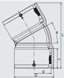
Компактная конструкция изделия и наличие углов 15°, 30°, 45° обеспечивают удобную прокладку трубопроводов. Имеет с обеих сторон интегрированные электросварные зоны для сокращения времени монтажа и для оптимальной теплопередачи во время сварки. Гладкий и гидравлически оптимизированный внутренний контур обеспечивает при применении труб с показателем SDR 17/17,6 отличную пропускную способность. Поверхность светлого цвета для оптимальной видимости при осмотре видеонспекцией.
