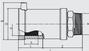
Компактное изделие. Часть ПЭ-НД имеет открытый нагревательный элемент для оптимальной теплопередачи, большую глубину сопряжения, особо широкую зону сварки, а также холодную зону, предотвращающую вытекание расплавленной массы на торце и в области перехода, упрощает выравнивание несоосности труб. Стальная часть неразъемная и надежно закреплена от прокручивания в ПЭ-НД. Запатентованная технология обжима позволяет обеспечить герметичность без применения эластомерных уплотнений.
