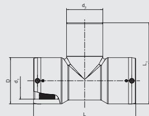
Имеет открытую нагревательную спираль для оптимальной теплопередачи, большую глубину сопряжения, особо широкую зону сварки, холодные зоны по бокам и в центре, предотвращающие вытекание расплавленной массы, упрощает выравнивание несоосности труб. Раздельные зоны сварки. Отводные патрубки SDR11 для приварки муфтами UB/MB.
