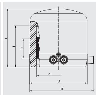
Имеет открытую нагревательную спираль для оптимальной теплопередачи, большую глубину сопряжения, особо широкую зону сварки, холодную зону на торце, предотвращающую вытекание расплавленной массы.
