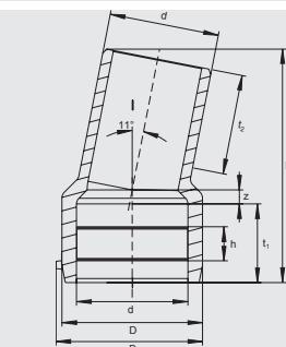
Для универсального и свободного от внутренних напряжений корректирования направления трубопровода, в т.ч. и в стесненных условиях. Достигается максимальная универсальность благодаря вариантам монтажа. Путем комбинации возможно создание отводов 22°, 33° и т.д. Муфтовая часть имеет открытую нагревательную спираль для оптимальной теплопередачи, большую глубину сопряжения, особо широкую зону сварки. Спиготная часть подходит для сварки с помощью муфт FRIALEN MB/UB.
