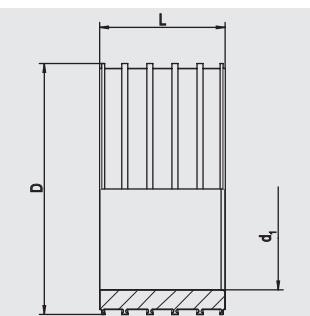
Соединительный элемент между колодцем из кирпича и FRIAFIT - вставной канализационной муфтой АЕМ. Широкие анкерные ребра по всей поверхности для более надежного крепления в колодце. Эластичная сердцевина для сглаживания напряжений. Большая толщина стенки для стабильности внутреннего диаметра.
