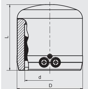
Имеют открытую нагревательную спираль для оптимальной теплоотдачи, большую глубину сопряжения, особо широкую зону сварки, а также предотвращающую вытекание расплавленной массы холодную зону на торце.
