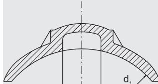
Для адаптации к трубам всех диаметров указанного диапазона с помощью прижимного приспособления FRIATOP (см. раздел FRIATOOLS). ПЭ-НД седловина для ремонта небольших повреждений труб с и без выхода среды. Для предотвращения выхода среды должна применяться отдельная заглушка\* (< d<sub>3</sub>). С открытым нагревательным элементом для оптимальной теплопередачи.
