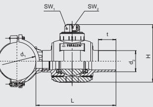
Компактное изделие из ПЭ-НД. Это комбинация из FRIALEN - седловины и FRIALEN - шарового крана для экономящего место и стоимость горизонтального монтажа, специально для врезки. Служит для врезки в действующие трубопроводы с давлением до 10 бар (газ) и 16 бар (вода) с помощью приспособления для врезки. (Мы рекомендуем Hütz & Baumgarten ([www.huetz-baumgarten.de](http://www.huetz-baumgarten.de))). Имеет открытый нагревательный элемент для оптимальной теплопередачи.
