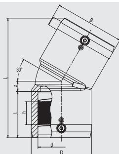
Имеет открытую нагревательную спираль для оптимальной теплопередачи, большую глубину сопряжения, особо широкую зону сварки, холодные зоны по бокам и в центре, предотвращающие вытекание расплавленной массы, упрощает выравнивание несоосности труб.
