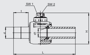
Компактное изделие из ПЭ-НД, привариваемое в процессе монтажа FRIALEN - муфтами MB или UB. Проход крана соответствует внутреннему диаметру трубы. Не требуется мероприятий по защите от коррозии. Открытое и закрытое положения определяются упорами. Запорный кран, не требующий технического обслуживания, управляемый с помощью монтажного набора (FRIALEN - BS).
