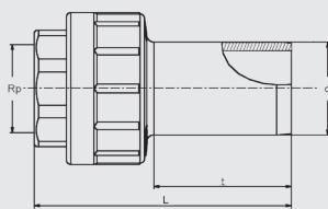
Компактное изделие. Полиэтиленовая часть дает возможность производить монтаж вне зависимости от положения и обеспечивает герметичное сварное соединение со всеми подходящими фасонными изделиями FRIALEN. Латунная часть неразъемная и надежно закреплена от прокручивания в ПЭ-НД.
