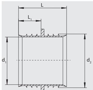
Для ремонта в безнапорном состоянии домовых вводов систем водоснабжения. Предотвращает попадание воды в сварную зону FRIALEN - муфт типов MB и UB.
