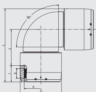
Имеет открытую нагревательную спираль для оптимальной теплопередачи, большую глубину сопряжения, особо широкую зону сварки, холодные зоны по бокам и в центре, предотвращающие вытекание расплавленной массы, упрощает выравнивание несоосности труб. Раздельные сварочные зоны.
