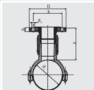
Компактное изделие из ПЭ-НД. Представляет собой комбинацию из патрубка-накладки FRIALEN и привариваемого фланца тип EFL. Седловина с открытым нагревательным элементом для оптимальной теплопередачи. Врезка производится в безнапорный трубопровод или с использованием обычных для этих целей приспособлений. Мы рекомендуем Huetz & Baumgarten ([www.huetz-baumgarten.de](http://www.huetz-baumgarten.de)). Фланец изготовлен в соответствии с DIN 2501, ч.1. Мы рекомендуем прокладки GST.
