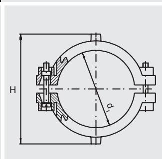
Компактное изделие из двух ПЭ-НД седловин для ремонта небольших повреждений труб без утечки транспортируемой среды. С открытым нагревательным элементом для оптимальной теплопередачи.
