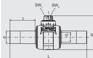
Компактное изделие из ПЭ-НД, привариваемое в процессе монтажа FRIALEN - муфтами MB или UB. Не требуется мероприятий по защите от коррозии. Открытое и закрытое положения определяются упорами. Запорный кран, не требующий технического обслуживания, управляемый с помощью монтажного набора (FRIALEN - BS).
