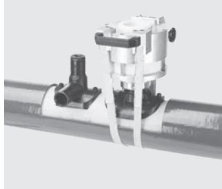
Используется для посадки на трубы и прижатия в процессе монтажа FRIALEN - седлообразных деталей типа Top-Loading всех диаметров в заданной области, используя эластичное пневматическое давление, и для создания оптимального давления расплава в зоне сварки.
