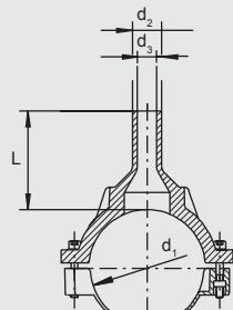
Компактное изделие из ПЭ-НД седловой формы с открытым нагревательным элементом для оптимальной теплопередачи и выходным патрубком для монтажа вместе с FRIALEN - муфтами типа MB/UB. Врезка выполняется в безнапорном состоянии с помощью подходящего приспособления для врезки Мы рекомендуем Huetz & Baumgarten ([www.huetz-baumgarten.de](http://www.huetz-baumgarten.de)).
