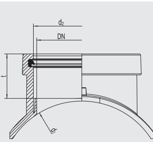
Переходной седловой отвод FRIAFIT ASA-TL/KG – компактное изделие из ПЭ-НД, состоящее из седлового привариваемого элемента и отвода с интегрированной в него муфтой (d 160). С помощью FRIAFIT® - переходного седлового отвода можно присоединить отвод из PVC/PP диаметром d150 мм к уже существующей канализационной системе из ПЭ-НД. Имеет открытую нагревательную спираль для оптимальной теплопередачи во время сварки. Область врезки не имеет нагревательной спирали.
