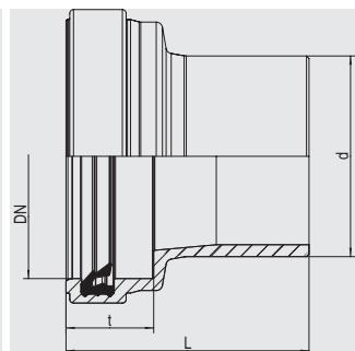
Переходник, позволяющий без изменения диаметра трубы переходить с полиэтиленовых труб (SDR 33 – SDR 17) на керамические трубы. Полиэтиленовая сторона может соединяться электромуфтой FRIAFIT AM или седловым отводом ASA-TL. Сторона для керамики работает по принципу раструбного соединения с использованием манжетного сальника из БСК (бутадиен-стирольный каучук) и глубокого посадочного места.
