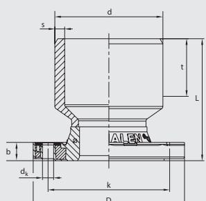
Компактное изделие из ПЭ-НД, представляющее собой комбинацию ввариваемого фланца EFL и редукции. Специально предназначено для соединения фланцевой арматуры с тройниками с переходом на DN 80 и DN 100. Для вертикального соединения гидрантов в комбинации с нашим отводом 90° и подпитником WF 90° d 110 или тройником. Нужно следить за монтажной высотой! Без внутреннего грата в месте стыка. Размеры фланца согласно DIN 2501, часть 1. Необходимы дополнительные шайбы для болтов.
