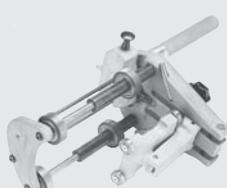
Ротационное устройство для надежного снятия оксидного слоя с патрубков фитингов без нагревательной спирали. Дополнительно возможно снятие оксидного слоя с труб из ПЭ-НД и РЕ-Ха (максимально на половину длины муфты d 710). Износостойчивый твердосплавный резец для обеспечения длительного срока службы. Равномерное снятие стружки посредством подпружиненного резца и автоматической подачи. Запасной резец и аэрозоль-смазка для ухода за инструментом прилагаются.
