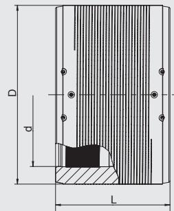
Имеет открытую нагревательную спираль для оптимальной теплопередачи, большая глубина вставки, широкие сварные зоны, широкие холодные зоны на концах и в центре для удержания давления расплава, упрощает выравнивание несоосности труб. С раздельными зонами сварки и индикаторами для каждой зоны.
