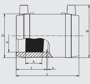
Применяется также как ремонтная муфта. Имеет открытую нагревательную спираль для оптимальной теплопередачи, большую глубину сопряжения, особо широкую зону сварки, холодные зоны по бокам и в центре, предотвращающие вытекание расплавленной массы, упрощает выравнивание несоосности труб.
