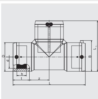
Имеет открытую нагревательную спираль для оптимальной теплопередачи на всех 3 выходах, большую глубину сопряжения, особо широкую зону сварки, холодные зоны по бокам и в центре, предотвращающие вытекание расплавленной массы, упрощает выравнивание несоосности труб. Линейная сторона сваривается за одну операцию, вследствие этого на соединение всего изделия необходимо только 2 сварочные операции.
