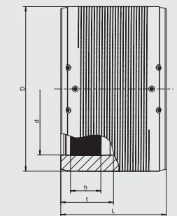
Имеет открытую нагревательную спираль для оптимальной теплопередачи, большую глубину сопряжения, широкую зону сварки, холодные зоны по бокам и в центре, предотвращающие вытекание расплавленной массы, упрощает выравнивание несоосности труб. Сварка труб SDR 11 - SDR 7,4.
