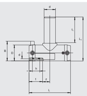
Прямой проход имеет открытую нагревательную спираль для оптимальной теплоотдачи, большую глубину сопряжения, особо широкую зону сварки, а также предотвращающие вытекание расплавленной массы холодные зоны сварки на торцах и в середине. Удлиненный отводной патрубок рассчитан на 2 сварки.
