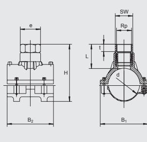
Представляет собой компактное седловое изделие из ПЭ-НД с открытым нагревательным элементом для оптимальной теплопередачи. Переход ПЭ-НД/красное литье является неразъемным и надежно запрессован в ПЭ-НД для предотвращения проворачивания. Служит для присоединения обычных латунных вентилей.
