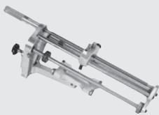
Ротационное устройство для надежного снятия оксидного слоя с труб из ПЭ-НД и РЕ-Ха на половину длины или на полную длину муфты. Износостойчивый твердосплавный резец для обеспечения длительного срока службы. Равномерное снятие стружки посредством подпружиненного резца и автоматической подачи. Запасной резец и аэрозоль-смазка для ухода за инструментом прилагаются.
