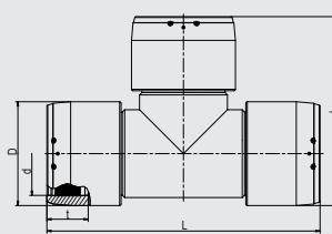
Имеет открытую нагревательную спираль для оптимальной теплопередачи на всех 3 выходах, большую глубину сопряжения, особо широкую зону сварки, холодные зоны по бокам и в центре, предотвращающие вытекание расплавленной массы, упрощает выравнивание несоосности труб. Раздельные сварочные зоны.
