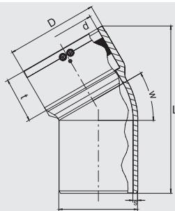
Незначительная потребность в площади благодаря компактному строению изделия и наличию углов 15°, 30°, 45° обеспечивают удобную прокладку трубопроводов. Муфта с открытой нагревательной спиралью для оптимальной теплопередачи во время сварки.
