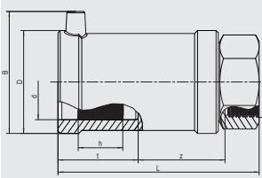
Компактное изделие. Часть ПЭ-НД имеет открытый нагревательный элемент для оптимальной теплопередачи, большую глубину сопряжения, особо широкую зону сварки, а также холодную зону, предотвращающую вытекание расплавленной массы на торце и в области перехода, упрощает выравнивание несоосности труб. Стальная часть неразъемная и надежно закреплена от прокручивания в ПЭ-НД. Запатентованная технология обжима позволяет обеспечить герметичность без применения эластомерных уплотнений.
