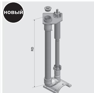
Компактное изделие седловидной формы из ПЭ-НД с открытым нагревательным элементом для оптимальной теплопередачи и выходным патрубком для FRIALEN - муфт типа MB/UB. Врезка без стружки в безнапорном состоянии при помощи интегрированной фрезы.
