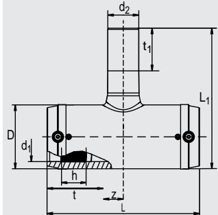
Имеет открытую нагревательную спираль для оптимальной теплопередачи, большую глубину сопряжения, особо широкую зону сварки, холодные зоны по бокам и в центре, предотвращающие вытекание расплавленной массы, упрощает выравнивание несоосности труб. Отводные патрубки SDR 11 для приварки муфтами UB/MB.
