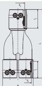
Разветвитель для труб (Y-вилка) компактном исполнении с тремя электросварными зонами с открытыми нагревательными элементами для оптимальной передачи тепла на трубу.
