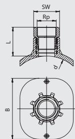
Применяется для адаптации ко всем диаметрам труб в заданной области с помощью прижимного приспособления FRIATOP (см. раздел FRIATOOLS). Компактное изделие. Представляет собой седловину из ПЭ-НД с открытым нагревательным элементом для оптимальной теплопередачи. Переход ПЭ-НД/бронза(красное литье) является неразъемным и надежно застопорен в ПЭ-НД для предотвращения проворачивания. Служит для присоединения обычных латунных вентилей.
