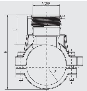
Компактный седловой фитинг с резьбовым отверстием для присоединения систем полива газонов, например: игровых полей или полей для гольфа. Имеет открытый нагревательный элемент для оптимальной теплопередачи. Встроенная латунная гильза с резьбой для безопасного соединения с фитингами ПВХ.
