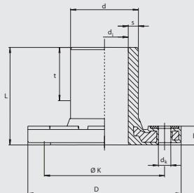
Бурт под фланец и фланец представляют собой единое целое. Металлическая вставка во фланце для предотвращения явлений холодной текучести. Привариваемая часть пригодна для работы с муфтами FRIALEN типов MB и UB. Размеры фланца согласно DIN 2501, часть 1. Необходимы дополнительные шайбы для болтов.
