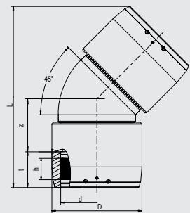
Имеет открытую нагревательную спираль для оптимальной теплопередачи, большую глубину сопряжения, особо широкую зону сварки, холодные зоны по бокам и в центре, предотвращающие вытекание расплавленной массы, упрощает выравнивание несоосности труб. Раздельные сварочные зоны. Разгрузка на строительной площадке производится легко благодаря приваренным болтам с проушиной.
