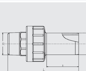
Компактное изделие. Полиэтиленовая часть дает возможность производить монтаж вне зависимости от положения и обеспечивает герметичное сварное соединение со всеми подходящими фасонными изделиями FRIALEN. Латунная часть неразъемная и надежно закреплена от прокручивания в ПЭ-НД.
