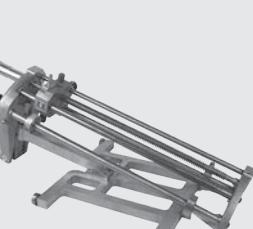
Ротационное устройство для надежного снятия оксидного слоя с труб из ПЭ-НД на половину длины или на полную длину муфты. Износостойчивый твердосплавный резец для обеспечения длительного срока службы. Равномерное снятие стружки посредством подпружиненного резца и автоматической подачи. Запасной резец и аэрозоль-смазка для ухода за инструментом прилагаются.
