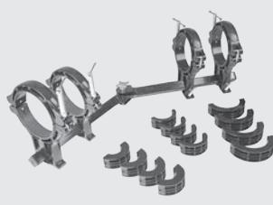
Позиционеры с регулировкой поворота (45° / 90°) и двумя зажимами для электромуфтовой сварки муфт, редукционных муфт, отводов 45° и 90° размером d 63, d 90, d 125 и d 180. Для изменения диаметра применяются специальные вкладыши. Поставляется в практичной сумке для переноски.
