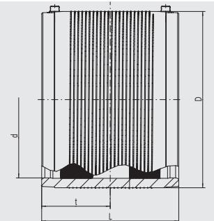
Имеет открытую нагревательная спираль для оптимальной теплопередачи во время сварки.
