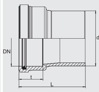
Переходник, позволяющий без изменения диаметра трубы переходить с полиэтиленовых труб (SDR 33 – SDR 17) на трубы из других материалов (ПВХ/ПП). Полиэтиленовая сторона может соединяться с электромуфтой AM или седловым отводом ASA-TL. Сторона для ПВХ/ПП работает по принципу раструбного соединения с использованием манжетного сальника из БСК (бутадиен-стирольный каучук) и глубокого посадочного места.
