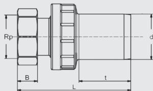
Латунная часть изделия надежно закреплена от прокручивания с ПЭ-НД, имеет накидную гайку для легкого и быстрого монтажа с зафиксированной трубой с наружной резьбой. Для применения в водоснабжении. Длина спигота не подходит для монтажа муфтами FRIALONG.
