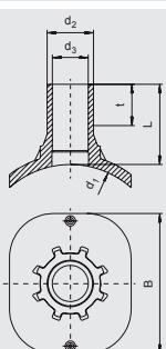
Для адаптации к трубам всех диаметров в заданной области с помощью прижимного приспособления FRIATOP (см. раздел FRIATOOLS). Компактное изделие из седловой формы из ПЭ-НД с открытым нагревательным элементом для оптимальной теплопередачи и выходным патрубком для FRIALEN - муфт типа MB/UB. Врезка без стружки в безнапорном состоянии с использованием обычных для этих целей приспособлений. Мы рекомендуем Huetz & Baumgarten ([www.huetz-baumgarten.de](http://www.huetz-baumgarten.de)).
