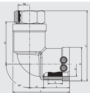
Компактное изделие. Часть ПЭ-НД имеет открытый нагревательный элемент для оптимальной теплопередачи, большую глубину сопряжения, особо широкую зону сварки, а также холодную зону, предотвращающую вытекание расплавленной массы на торце и в области перехода, упрощает выравнивание несоосности труб. Стальная часть неразъемная и надежно закреплена от прокручивания в ПЭ-НД. Запатентованная технология обжима позволяет обеспечить герметичность без применения эластомерных уплотнений.
