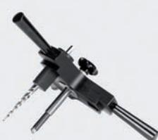
Комбинированное, универсальное устройство для прижатия в процессе монтажа и проведения врезки всех FRIAFIT - седловидных изделий типа ASA-TL и ASA-TL/KG (см. раздел FRIAFIT). Служит для прижатия и для создания необходимого давления расплава в зоне сварки, а также для врезки через отвод в безнапорном состоянии после истечения заданного времени охлаждения.
