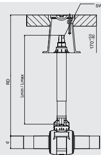
Телескопическая приводная штанга для управления кранами FRIALEN - KHP, KН, KHW, AKHP и AKHP-TL через ковер. В заданной области (RD) бесступенчатая установка по высоте, также в смонтированном состоянии. Самофиксация при любом выдвинутом положении. Устойчив к коррозии. Исполнение с ключом 14 – специально для домовых вводов.
