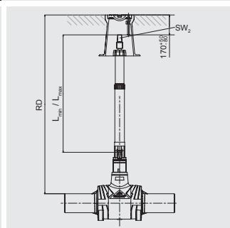
Телескопическая приводная штанга для управления FRIALOC – запорной арматуры из ПЭ для использования с ковером. Оптимально подходит друг к другу. В заданной области (RD) бесступенчатая установка по высоте. Простой монтаж посредством применения фиксирующей защелки. Исполнение – из оцинкованной или нержавеющей стали.
