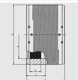
Имеет открытую нагревательную спираль для оптимальной теплопередачи, большую глубину сопряжения, особо широкую зону сварки, холодные зоны по бокам и в центре, предотвращающие вытекание расплавленной массы, упрощает выравнивание несоосности труб. Для сварки UB d1000 и более подходит исключительно сварочный аппарат FRIAMAT XL (см. раздел FRIATOOLS).
