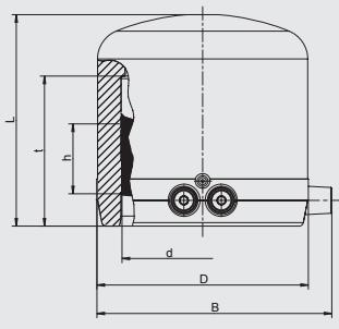
Имеет открытую нагревательную спираль для оптимальной теплопередачи, большую глубину сопряжения, особо широкую зону сварки, холодную зону на торце, предотвращающую вытекание расплавленной массы, упрощает выравнивание несоосности труб.
