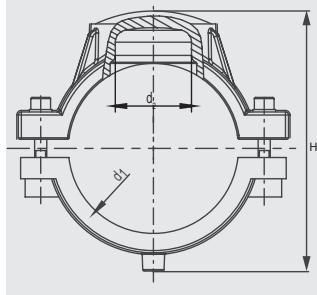
Компактное изделие из двух ПЭ-НД седловин для ремонта небольших повреждений труб с и без выхода транспортируемой среды. С открытым нагревательным элементом для оптимальной теплопередачи.
