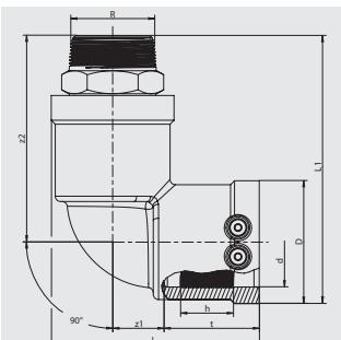
Компактное изделие. Часть ПЭ-НД имеет открытый нагревательный элемент для оптимальной теплопередачи, большую глубину сопряжения, особо широкую зону сварки, а также холодную зону, предотвращающую вытекание расплавленной массы на торце и в области перехода, упрощает выравнивание несоосности труб. Стальная часть неразъемная и надежно закреплена от прокручивания в ПЭ-НД. Запатентованная технология обжима позволяет обеспечить герметичность без применения эластомерных уплотнений.
