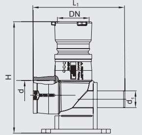
Для подключения гидранта адаптером BAIO либо к фланцу. Компактная деталь, состоящая из отвода FRIALEN 90° с подпятником (см. WF 90°) и муфтового соединения BAIO из ковкого чугуна с прокладкой. Литая муфта BAIO закреплена в полиэтилене неразъемно и неподвижно. Просьба следовать инструкции по монтажу для соединительной системы "BAIO". Для подземного гидранта необходимо предусмотреть защиту насадок BAIO от грязи и скручивания.
