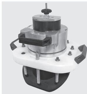
Прижимное устройство для FRIAFIT - седловидных изделий типа ASA-TL и ASA-TL/KG (см. раздел FRIAFIT), особенно для плотно прилегающих вставок из ПЭ-НД от DN 200 до DN 500 мм и труб из ПЭ-НД диаметром d 630 мм. Для прижатия и создания необходимого в зоне сварки давления в процессе сварки. Состоит из анкерного устройства, коронки (диаметр 95 мм), патрона с разъемом SDS max, центровочного сверла с удлинителем, и воздушного насоса.
