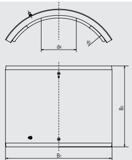
Компактное изделие из ПЭ-НД для ремонта таких повреждений, как царапины, борозды или трубы\*. Накладка с открытой нагревательной спиралью для оптимальной теплопередачи. Для монтажа с помощью монтажного приспособления VACUSET XL (см. раздел FRIATOOLS). С жидкостными индикаторами для визуального контроля процесса сварки. Повреждение должно находиться внутри заданной для ремонта поверхности d<sub>R</sub> и не должно перекрываться зоной сварки.
