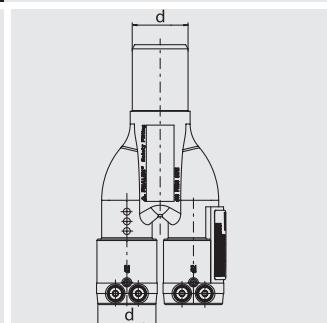
Разветвитель для труб (Y-вилка) компактном исполнении с двумя электросварными зонами и ПЭ-патрубком спигот на конце для соединения труб, например, через отвод FRIALEN 90°.
