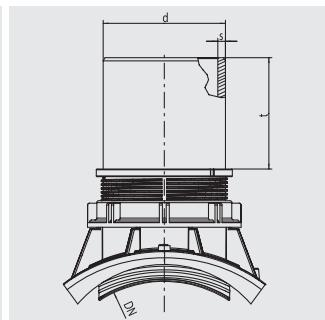
Для соединений боковых отводов от керамических труб с трубами ПЭ-НД. Для новых врезок, а также конструкций – без демонтажа или полной замены основного трубопровода. Выходной патрубок d 160 дает возможность регулировать проход SDR 17/17,6. Его яркая внутренняя поверхность облегчает обзор во время видеонспекции. Подходит для сварки с муфтами AM или ABM/ABMS.
