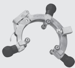
Устройство для надежного снятия оксидного слоя с концов труб из ПЭ-НД и РЕ-Ха одного конкретного диаметра, а также с поверхностей для посадки седлообразных фитингов. Поворотный резец имеет две режущие поверхности (двойной срок службы). Удобство посадки на трубу за счет открывающейся конструкции приспособления.
