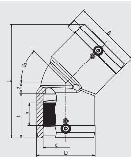
Имеет открытую нагревательную спираль для оптимальной теплопередачи, большую глубину сопряжения, особо широкую зону сварки, холодные зоны по бокам и в центре, предотвращающие вытекание расплавленной массы, упрощает выравнивание несоосности труб.
