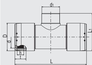
Имеет открытую нагревательную спираль для оптимальной теплопередачи, большую глубину сопряжения, особо широкую зону сварки, холодные зоны по бокам и в центре, предотвращающие вытекание расплавленной массы, упрощает выравнивание несоосности труб. Раздельные зоны сварки. Отводные патрубки SDR11 для приварки муфтами UB/MB. Другие диаметры выходных патрубков можно получить с помощью редукционных муфт MR d225/160, MR 110/90 или MR 110/63.
