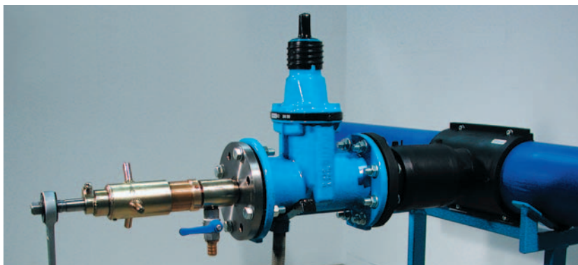
Рис. 3: Врезка через стандартный фланец, задвижку и комбинацию деталей типа SA и EFL
