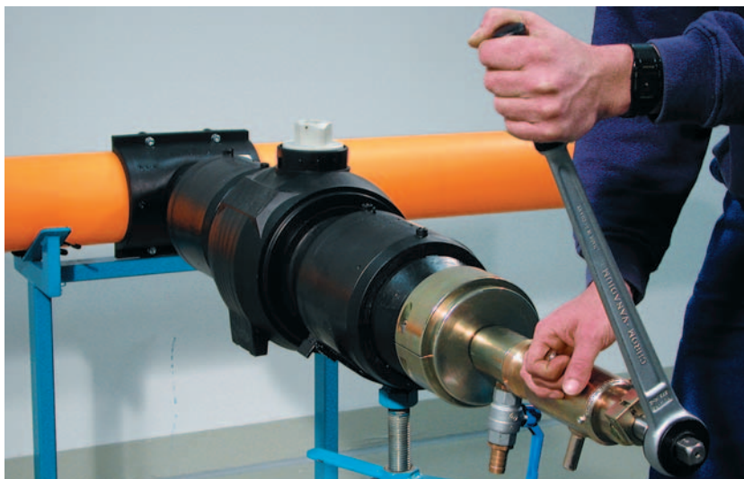
Рис. 4: Врезка через герметизирующее приспособление и шаровой кран
