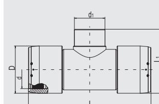
Имеют открытую нагревательную спираль для оптимальной теплопередачи, большую глубину сопряжения, особо широкую зону сварки, холодные зоны по бокам и в центре, предотвращающие вытекание расплавленной массы, не требуют при работе специальных позиционеров и приспособлений. Раздельные зоны сварки. Отводные патрубки SDR11 для приварки муфтами UB/MB. Другие диаметры выходных патрубков можно получить с помощью редукционных муфт MR d225/160, MR 110/90 или MR 110/63.
