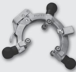
Устройство для надежного снятия оксидного слоя с концов труб из ПЭ-ВП и РЕ-Ха одного конкретного диаметра, а также с поверхностей для посадки седлообразных фитингов. Поворотный резец имеет две режущие поверхности (двойной срок службы). Простота посадки на трубу за счет открывающейся конструкции приспособления.
