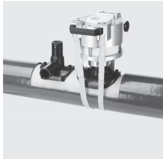
Используется для посадки на трубы и прижатия в процессе монтажа FRIALEN – седлообразных деталей типа Top-Loading всех диаметров в заданной области, используя эластичное пневматическое давление, и для создания оптимального давления расплава в зоне сварки.
