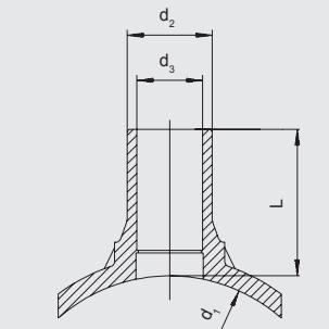
Для адаптации к трубам **всех** диаметров в заданной области с помощью прижимного приспособления FRIALEN FRIATOP (см. стр. 17). Компактное изделие из седловидной формы из ПЭ-ВП с открытой нагревательным элементом для оптимальной теплопередачи и выходным патрубком для FRIALEN - муфт типа MB или UB. Врезка без стружки в безнапорном состоянии с использованием обычных для этих целей приспособлений. Мы рекомендуем Huetz & Baumgarten ([www.huetz-baumgarten.de](http://www.huetz-baumgarten.de)).
