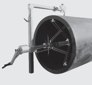
Для надежного удаления оксидного слоя на муфтах большого диаметра из ПЭ-ВП d 800-d 1200 SDR 11 – SDR 33. Модульная конструкция для простого обращения и быстрого монтажа. Быстрый подбор соответствующего диаметра. Находящийся по центру привод посредством приводной рукоятки. Автоматическая компенсация овальности трубы и допусков посредством подпружиненного резца и автоматической подачи. Поворотный резец имеет две режущие поверхности (двойной срок службы).
