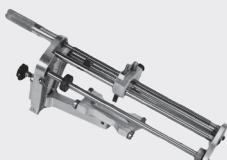
Ротационное устройство для надежного снятия оксидного слоя с труб из ПЭ-ВП и РЕ-Ха на половину длины или на полную длину муфты. Износостойчивый твердосплавный резец для высокой временной стойкости (длительный срок службы). Равномерное снятие стружки посредством подпружиненного резца и автоматической подачи. Запасной резец и FRIATEC аэрозоль-смазка по уходу прилагаются.
