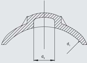
Для адаптации к трубам всех диаметров указанного диапазона с помощью прижимного приспособления FRIALEN FRIATOP (см. стр. 17). ПЭ-ВП седловина для ремонта небольших повреждений труб с и без выхода среды. Для предотвращения выхода среды должна применяться отдельная пробка\* ( $\leq d_3$ ). С открытым нагревательным элементом для оптимальной теплопередачи.
