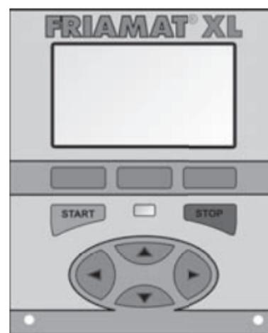
**Клавиши управления:** клавиши управления окрашены в голубой цвет, расположены в верхней части клавиатуры (прямо под макси-дисплеем) на планке серого цвета. Клавиши управления не подписаны, т.к. имеют различные функции в зависимости от процесса ввода, которые указаны в самой нижней части макси-дисплея (см. гл. 4.2 и 4.3)
