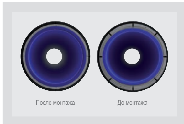
Адаптивная муфта KM-XL в смонтированном / несмонтированном состоянии
