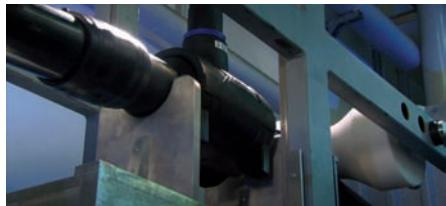
Основанием для разработки надежной и прочной конструкции служили динамические испытания, в ходе которых арматура 2500 раз полностью открывалась и закрывалась при максимальном рабочем давлении и скорости потока. Эти испытания выходят далеко за рамки нормативных требований и требований потребителей. Надежность стопоров в приводе в любом случае превосходит значения нормативных требований для металлических запорных арматур.
