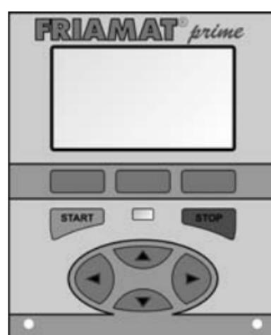
**Клавиши управления:** Клавиши управления голубого цвета, находятся на панели в самом верху (прямо под макси-дисплеем), на серой полоске. Клавиши управления не подписаны, т.к. их функции отличаются в зависимости от меню и каждый раз заданы на нижней строке макси-дисплея (см. часть 5.2 и 5.3).
